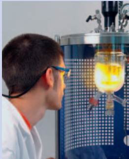
Glasgefäss zur visuellen Überwachung der Reaktion
