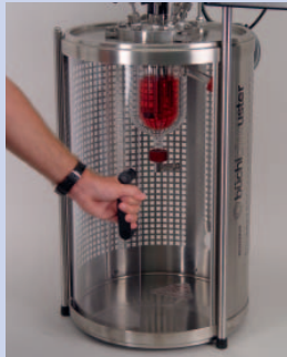
Polycarbonat-Schutzscheibe garantiert optimalen Personenschutz
